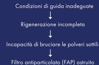
La sostituzione di un FAP bloccato senza una diagnosi corretta del vero problema bloccherà un'altra volta il nuovo FAP!
